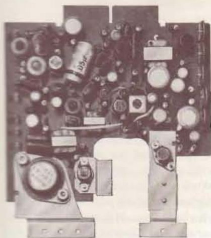
Foto 2 a. Afbuig PC, waarop verticale en horizontale synchronisatie en versterkers zijn aangebracht.
